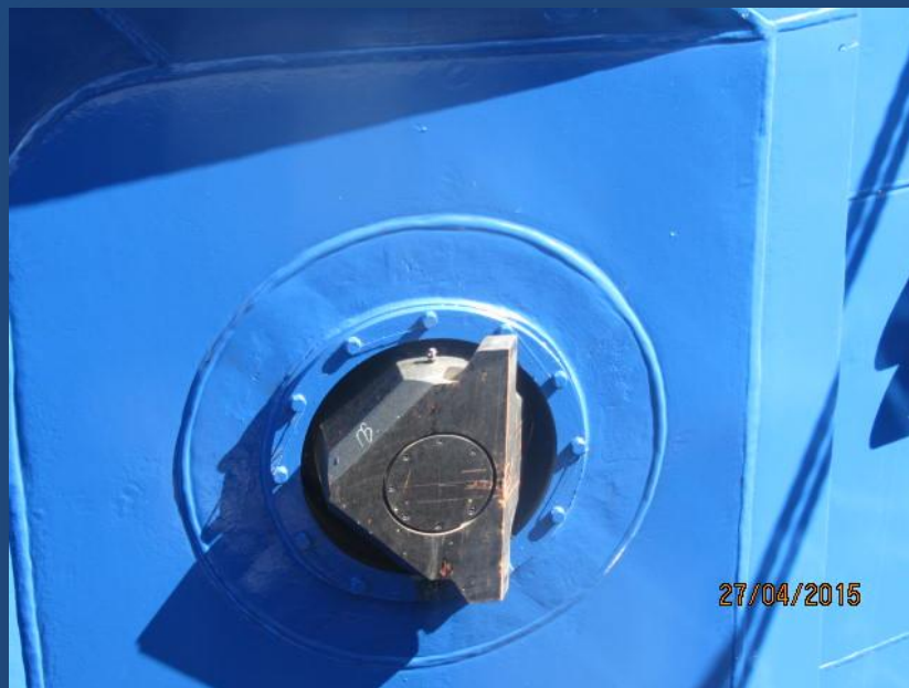
Элемент сцепного устройства на буксире-толкаче
