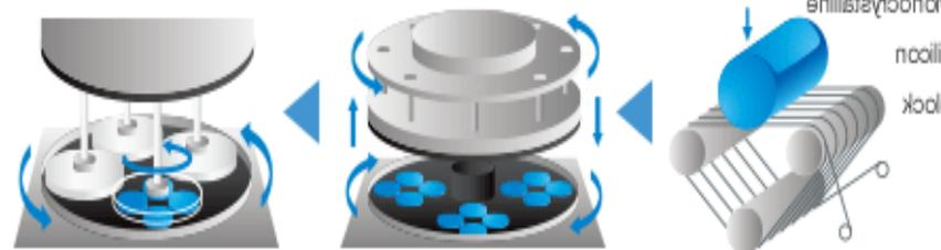
Получение полированных пластин-подложек диаметрами от 50 до 200 мм
