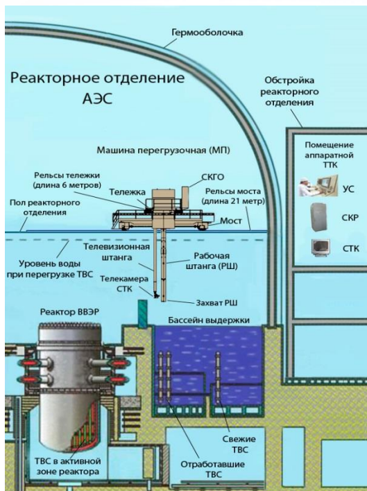
Рабочая зона ТТК на АЭС
