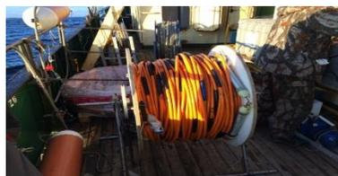
Создан комплекс с твердотельной буксируемой сейсмокосой
